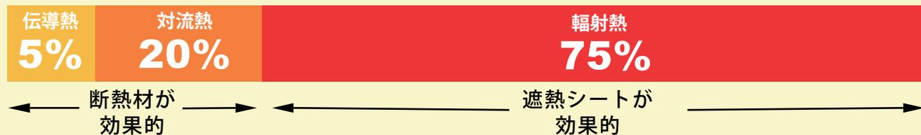
遮熱シートは、この輻射熱をブロックします（伝導熱や対流熱の抑制は、断熱材が向いています）。
